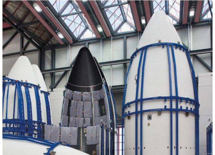
Die Nutzlastverkleidung von Ariane 5 in den Produktionshallen der RUAG in Emmen. Bild: RUAG
