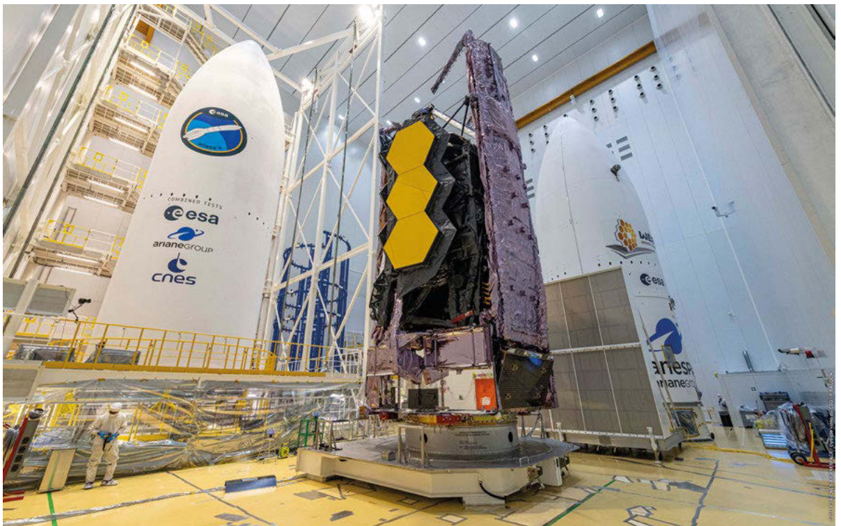
Das James-Webb-Weltraumteleskop vor dem Anbringen der Nutzlastverkleidung der Ariane 5 im Reinraum des Weltraumbahnhofs in Kourou in Französisch-Guayana. Bild: ESA
