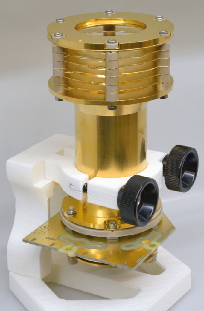
Prototype d'un spectromètre de masse à ionisation/ablation laser (LIMS) construit dans le cadre d'un projet soutenu en vertu de l'OANS, en vue d'une potentielle utilisation lors d'une future mission lunaire. Photo : Université de Berne
