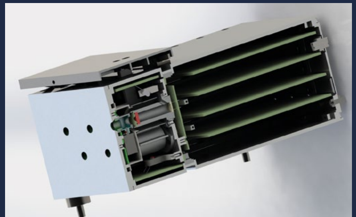
Vue transversale modélisée de l'Extreme Ultraviolet Solar Spectral Irradiance Monitor (SoSpIM), cofinancé sur la base de l'OANS et développé à l'Observatoire physico-météorologique de Davos pour la future mission solaire SOLAR-C, sous la direction de la JAXA. Photo : ©PMOD/WRC
