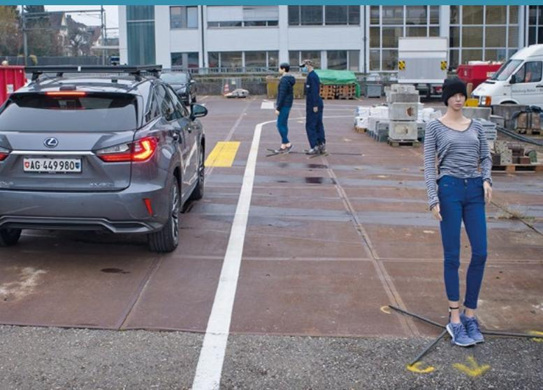
Dans le cadre du projet « Automated Driving Sensor Testing Vehicle », le comportement de capteurs intégrés à des véhicules autonomes est étudié en conditions réelles sur une piste d'essai de l'Empa. Photo : Empa
