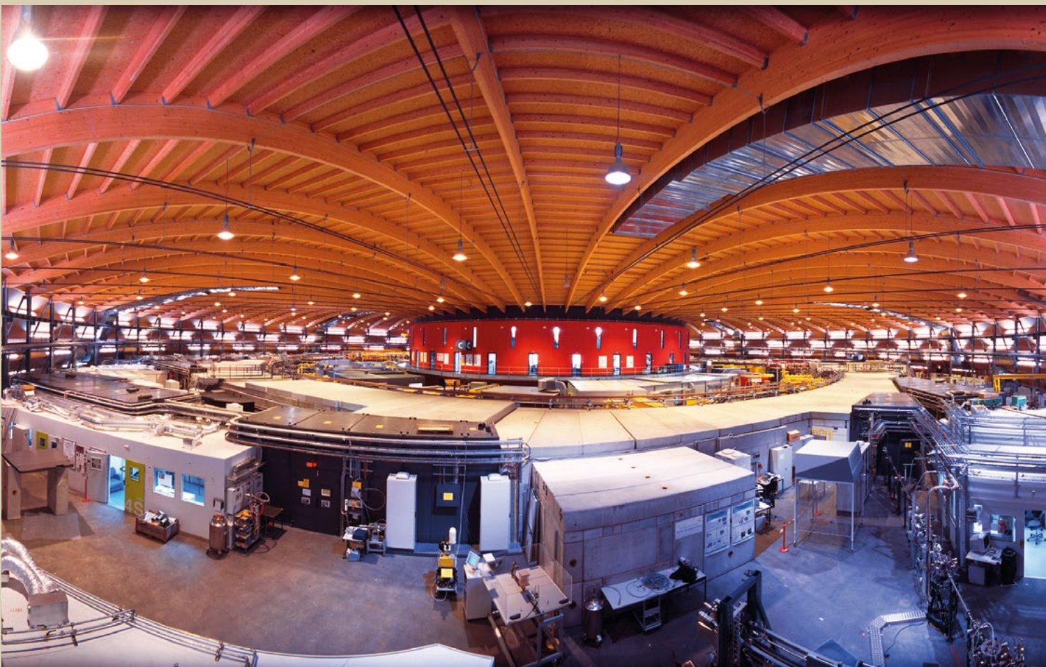
Die Synchrotron Lichtquelle Schweiz (SLS) am Paul Scherrer Institut liefert extrem helles, stark gebündeltes Röntgenlicht und ist eine schweizweit einmalige Grossforschungsanlage. Mit der SLS untersuchen Forschende kleinste Strukturen bis auf die Ebene von Atomen und entwickeln neue Medikamente und Materialien. Bild: Paul Scherrer Institut
