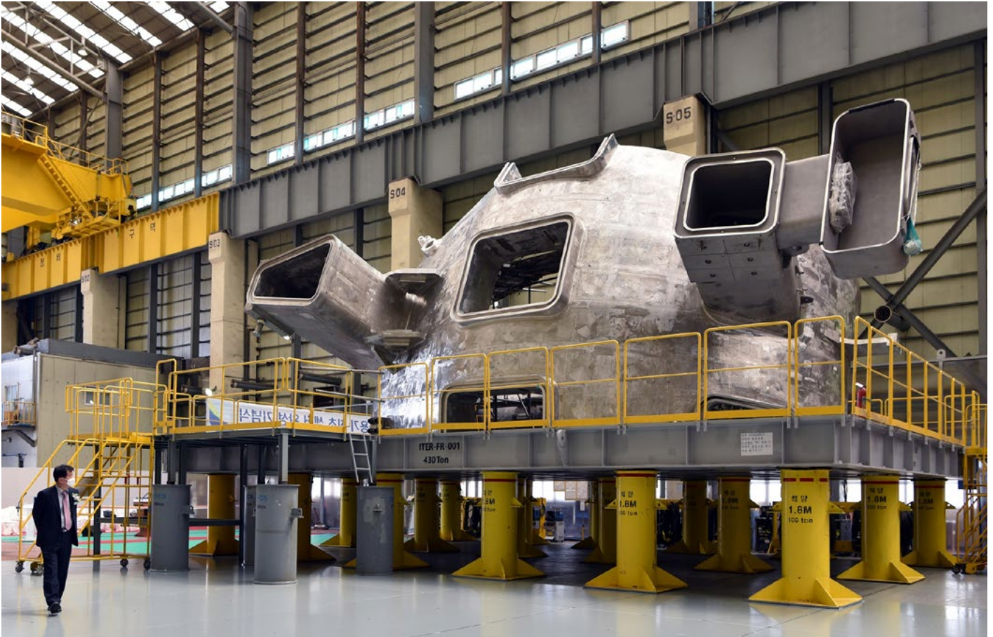
Premier secteur de la chambre à vide d'ITER assemblé par la Corée du Sud. Haut de 14 mètres, le secteur pèse 440 tonnes et comprend 1380 mètres de soudure répondant aux standards nucléaires. Photo : mà
